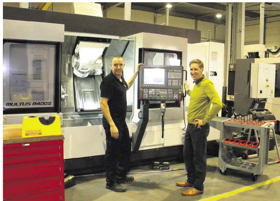
Ted Jansen (l.) en een operator bij de Okuma Multus B400 II, waarmee onderdelen compleet kunnen worden bewerkt
